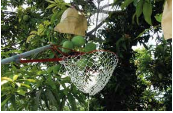
চিত্র: BARI আম সংগ্রহ যন্ত্র দ্বারা খাটো বোটা যুক্ত আম সংগ্রহ।
