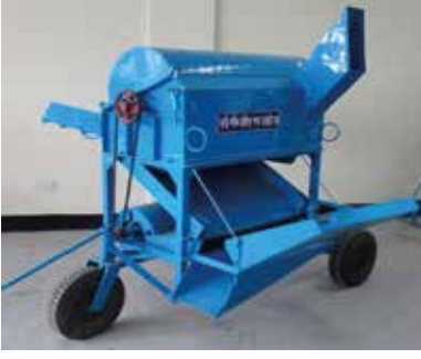
চিত্র: মটর চালিত মাড়াই যন্ত্র দিয়ে পড থেকে বীজ বের করতে হবে।
